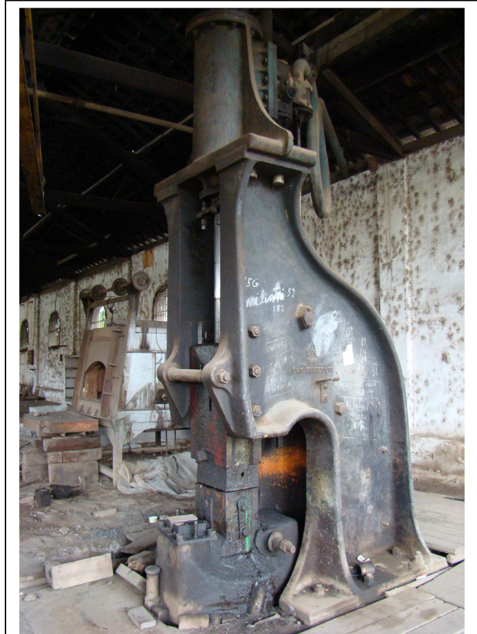
IMAGEM 15. Marteleto a vapor. Seção de ferraria. Posteriormente adaptado para trabalhar com ar comprimido. Um dos poucos equipamentos que sobraram depois do sucateamento das máquinas da Oficina
