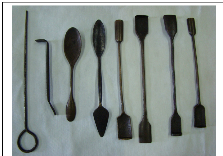
Figura 18 – Conjunto de ferramentas usadas pelos fundidores na modelagem das caixas de areia.
